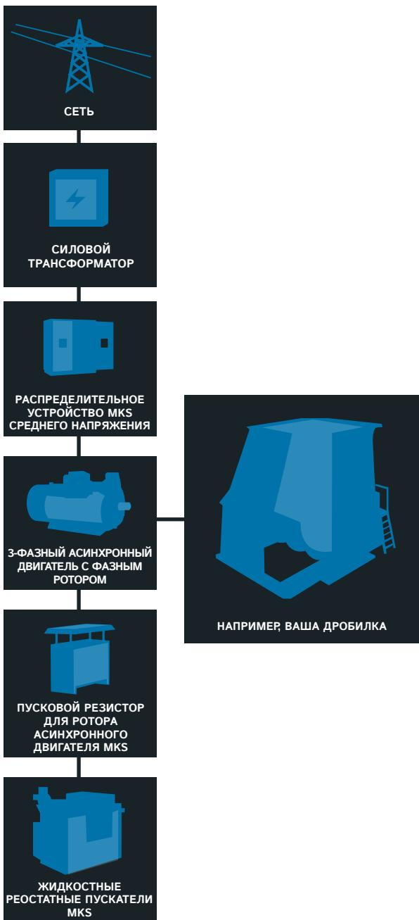
Мы поставляем компоненты для приводных систем - жидкостные реостатные пускатели, распределительные устройства и пусковые резисторы, точно отвечающие требованиям заказчиков.
